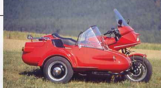
Auch ein ungewöhnliches Gespann: BFG mit Greif-II-Beiwagen. An diesem Gespann zeigte Peter Sauer auch die von ihm aufgelegten Federstreben.
