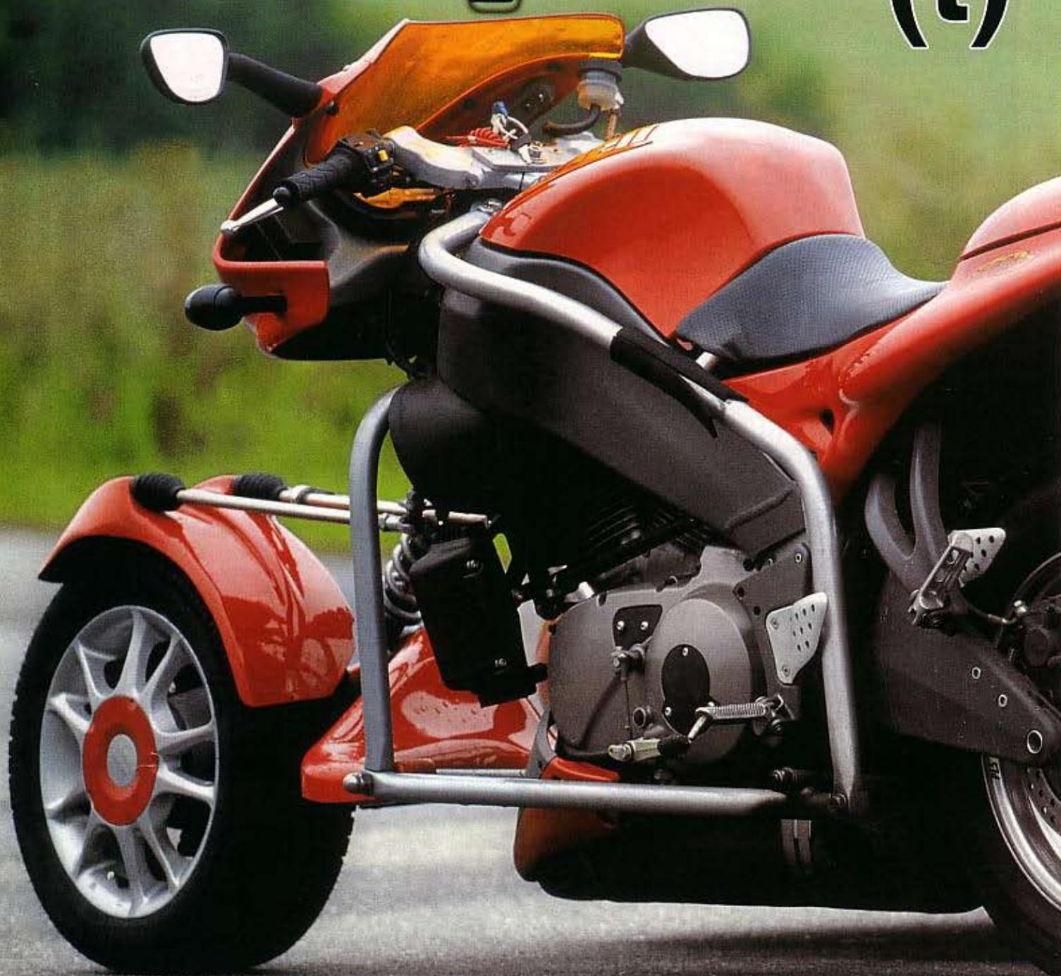
Im hohen Norden entstand ein Hightech-Gespann auf Basis der Buell XB12R – mit Stahlrohrrahmen, Achsschenkelenkung und variablem Seitenwagen
