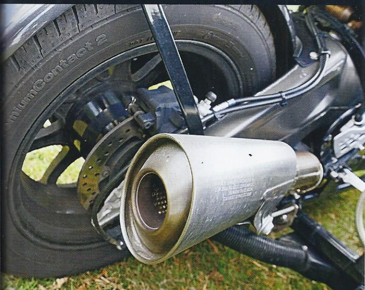
Die Müller-Sauer-Achsschenkelenkung (MSA) wird von einem Bilstein-Dämpfer beruhigt und stabilisiert den Geradeauslauf. Zur Kühlung der Seitenwagenbremse gibt es im Beiboot einen Luftschacht. Die Hinterachsgarnitur wurde ebenso beibehalten wie der originale Schalldämpfer
