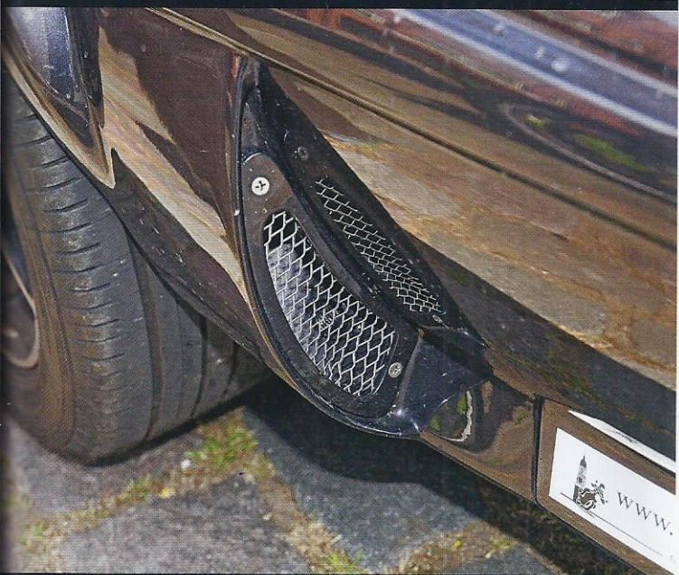
Die Müller-Sauer-Achsschenkelenkung (MSA) wird von einem Bilstein-Dämpfer beruhigt und stabilisiert den Geradeauslauf. Zur Kühlung der Seitenwagenbremse gibt es im Beiboot einen Luftschacht. Die Hinterachsgarnitur wurde ebenso beibehalten wie der originale Schalldämpfer
